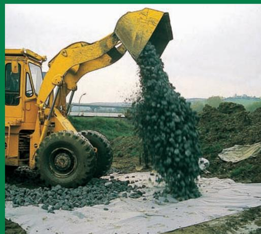
Test sul danneggiamento meccanico
